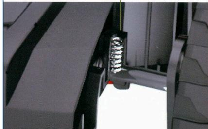
L'esclusiva molla di smorzamento dell'assale anteriore del tosaerba SISTEMA garantisce la stabilità del tosaerba anche su terreni irregolari, riduce le vibrazioni e favorisce la falciatura.
